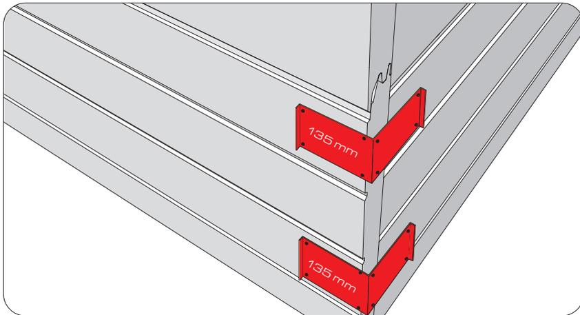
Nach der Befestigung der Sandwichplatten an der Konstruktion, beginnt mit folgenden Schritten die Eckenverarbeitung: L-Profile 047 verteilen, ins Lot bringen, und an die Außenschale anschrauben.
