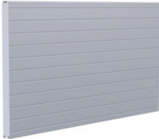
**ThermaStyle PRO** ist eine Sandwichplatte mit Styroporkern EPS, die an die Stützkonstruktion mit einem, von der Fassadenseite unsichtbarem Verbindungsstück befestigt werden kann. Dadurch erhalten Sie mit der ThermaStyle PRO eine einheitliche Fläche, die keinerlei durch Verbindungsmittel gestört wird. Alternativ können Sie die Sandwichplatten auch traditionell, also direkt mit dem Verbindungsmittel durch die Plattendicke an die Tragkonstruktion (aus Holz, Stahl oder Stahlbeton) montieren.
