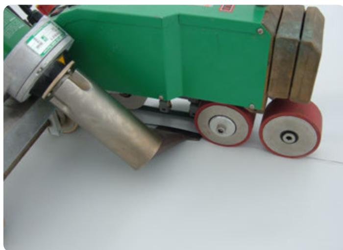
Soudage par automate- les plis du recouvrement sur le joint longitudinal
