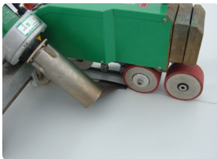
Suvirinimas automatu- uždėjimo klostės ant išilgos sandūros
